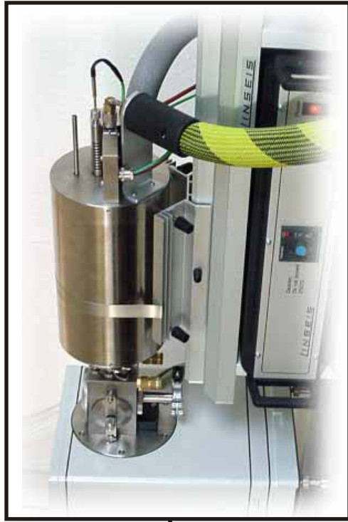
Tieftemperaturofen mit temperaturbereich von -150°C bis 500 °C, mit Kopplungsteil an das FTIR - Spektrometer
