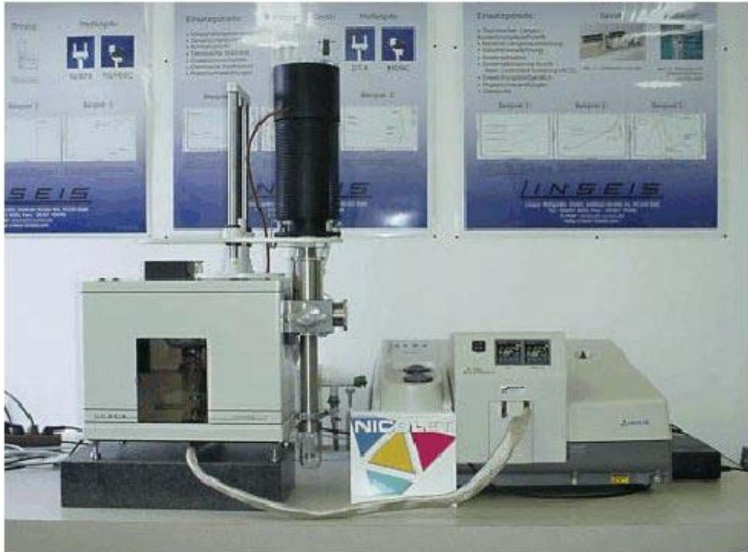
In Zusammenarbeit mit der Fa. Nicolet hat die Fa. Linseis Messgeräte GmbH eine Kopplung von Thermowaage mit DTA bzw. HDSC – Messsystem und einem Infrarot-Spektrometer des Typs NEXUS realisiert und nun aktuell im Lieferumfang.
